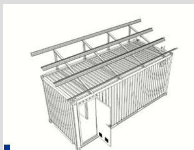
Fase 3: Montaje de la estructura soporte Para los módulos fotovoltaicos
