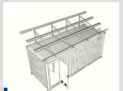
Fase 3: Montaje de la estructura soporte Para los módulos fotovoltaicos
